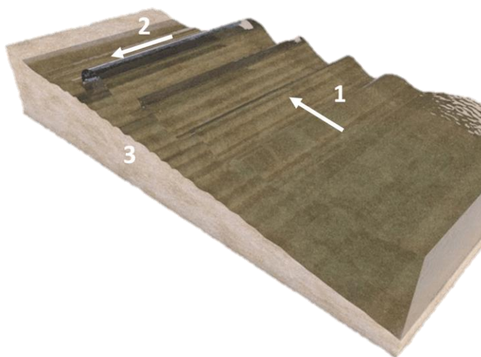
Figura 2.1 Rappresentazione 3D di un tratto di costa con individuazione delle forzanti studiate nel presente lavoro, onde [1] e correnti [2], e della formazione di forme di fondo [3].
