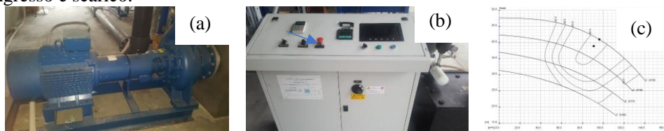
Figura 3.11 Generazione moto permanente. a) pompa; b) pannello di controllo; c) curve caratteristiche fornite dal costruttore.
