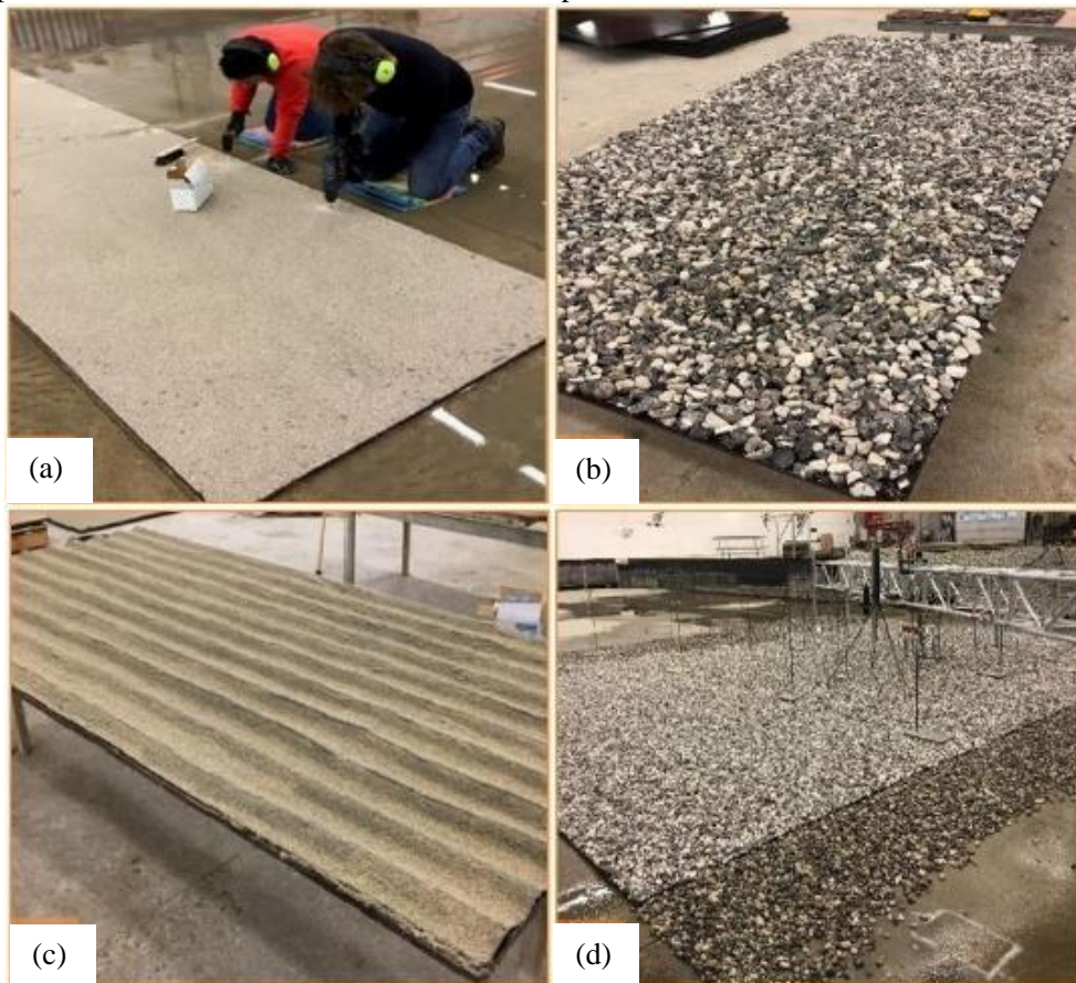
Figura 3.7 a) b) c) Esempio dei tre diversi pannelli utilizzati per il fondo. d) Disposizione delle pietre all'esterno dell'area del pannello.
