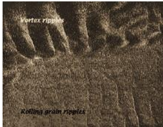
Figura 2.17 Transizione da rolling grain ripples a vortex ripples.
