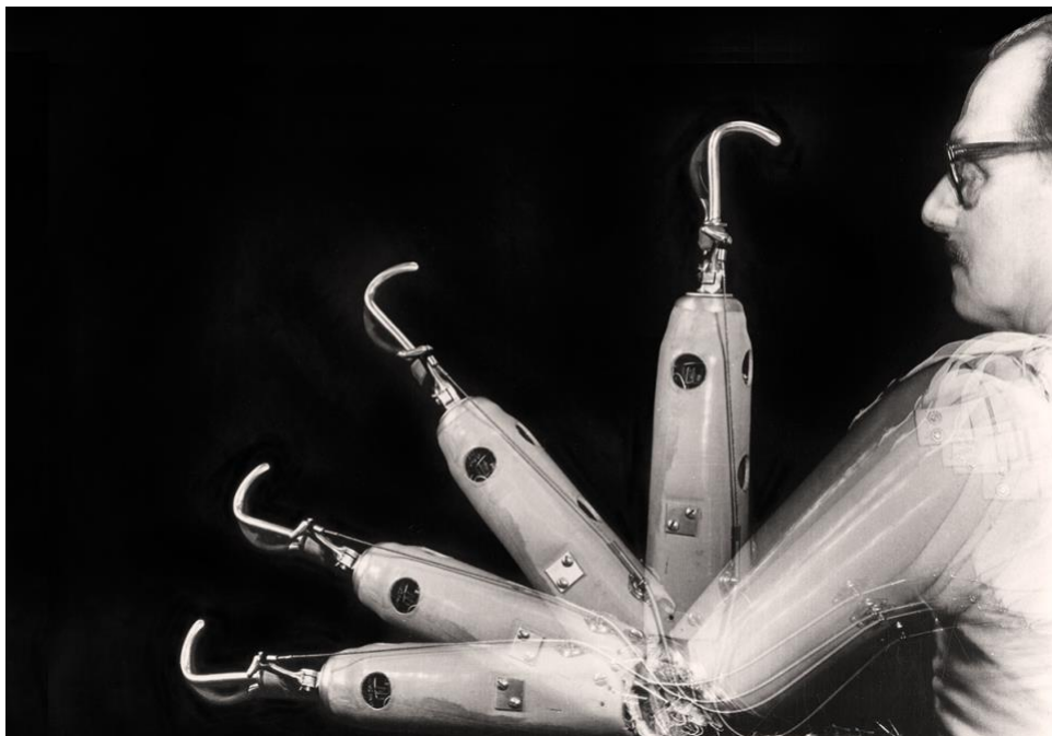
Cronofotografia dei movimenti possibili attraverso l'utilizzo della Boston Arm brevettata da Wiener
