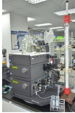
Figura 18. AKTA purifier utilizzato per gel filtrazione su resina G-10 per la desalificazione delle frazioni purificate su DEAE-FF. Le dimensioni della colonna erano 90x1.5cm, la fase mobile era acqua bi-distillata e il flusso era 1ml/min.
