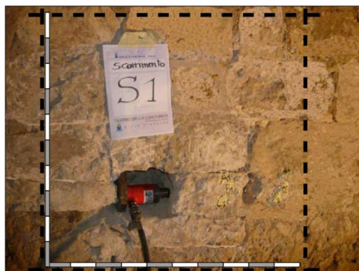
Ingranamento nel piano del paramento L.M.T=1,31 - N.R.
