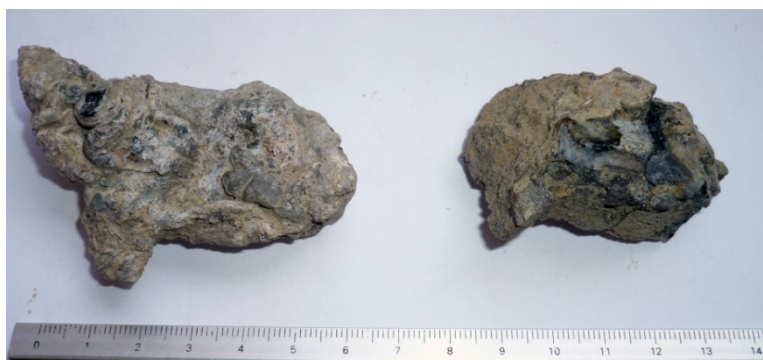
Fig. 38 - Scorie della fase di calcificazione delle materie prime
