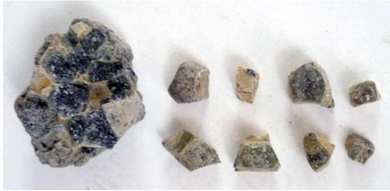
Fig. 55 - Fondo di un crogiolo, con segni di distacchi, e distacchi
