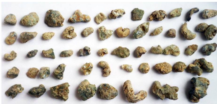
Fig. 41 - Probabili prove di fluidità della fritta
