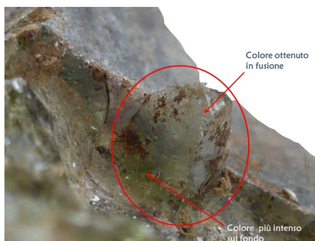
Fig. 54 - Particolare della vetrificazione interna di un crogiolo
