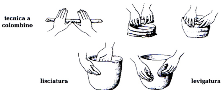
Fig. 46 - Tecnica a colombino per la realizzazione di crogioli 197
