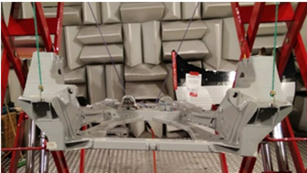
Fig. 3.5 Sottotelaio sospeso mediante elastici
