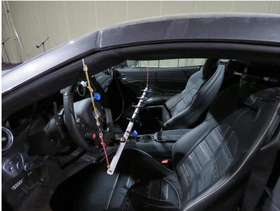
Fig. 4.7 Posizionamento di un array di microfoni all'interno dell'abitacolo
