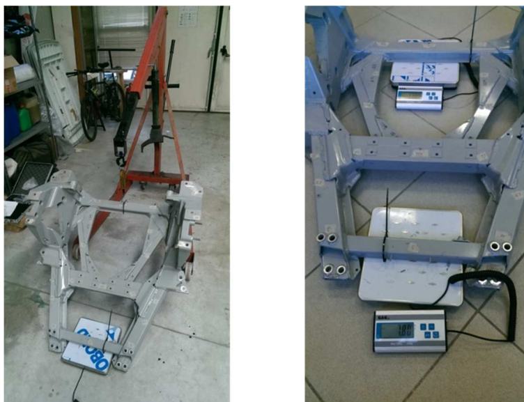
Fig. 3.18 Fasi del calcolo del baricentro per via sperimentale
