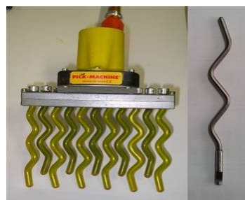
Figura 34. Prototipo di agevolatrice con testata di raccolta modificata per la raccolta delle bacche di mirto e particolare dell'organo di lavoro (Ondulina).
