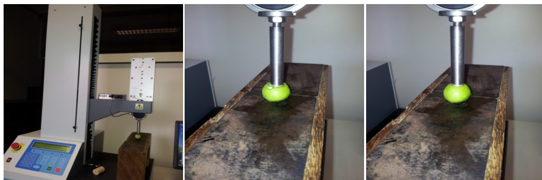
Figura 47. Texture Analyzer Chatillon mod. LF Plus 500. Prova “Compressione Rottura 40-0650”, particolare dell'esecuzione della prova con puntale in acciaio a sezione circolare del diametro di 10 mm.
