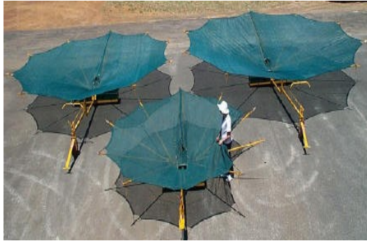
Figura 51. Sistema di intercettazione ad ombrello rovesciato, modelli con differenti diametri (6,5m; 5,5m; e 4m)
