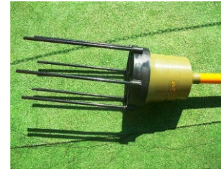
Figura 17. La testata rotante a sei denti oscillanti dell'Oliviero Evolution.
