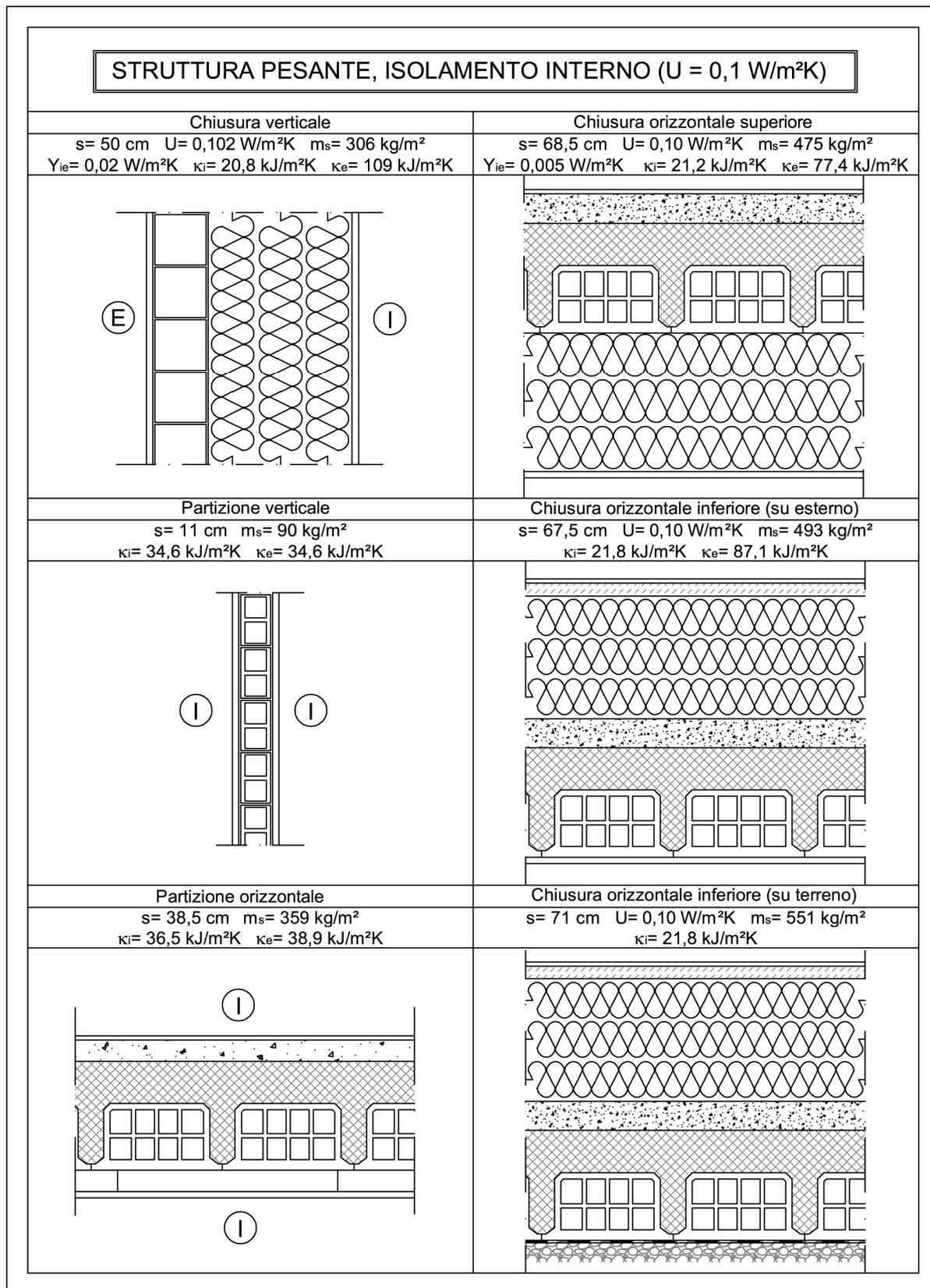
Figura 3.25 Scheda relativa alla struttura edilizia “pesante” con materiale isolante posizionato all’interno e alto livello di isolamento termico.
