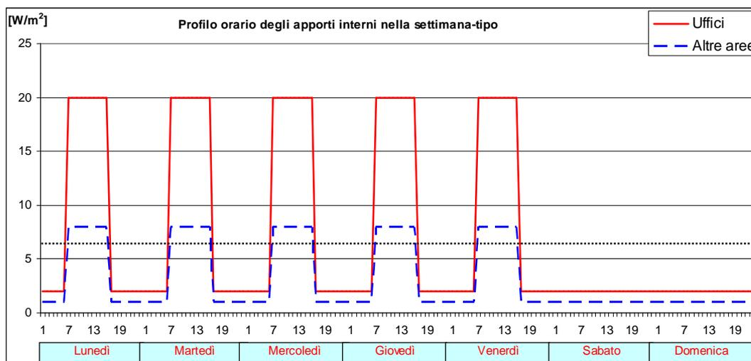
Figura 3.14 Profilo orario degli apporti interni globali nella settimana-tipo, suddiviso in uffici ed altre aree del piano-tipo oggetto di studio. Il grafico è ottenuto a partire dai valori riportati in Figura 3.11 e in Figura 3.12.
