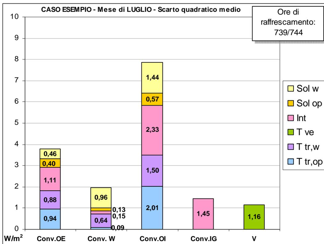
Figura 2.12 Esempio di rappresentazione della metodologia d'analisi termica. Scarto quadratico medio (luglio) dei termini del bilancio termico in relazione alle sollecitazioni termiche, espressi in termini di potenza termica media per unità di pavimento climatizzato, in riferimento al caso studio in esame.
