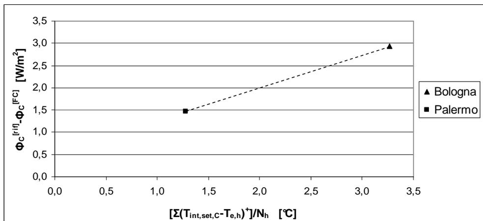
Figura 4.22 Relazione tra la differenza del carico frigorifero medio mensile, in assenza ("rif") e in presenza ("FC") del *free cooling*, e la differenza cumulata positiva tra il set-point di attivazione dell'impianto (26 °C) e la temperatura esterna riferita alle ore di luglio ( $N_h$ ), per le due località analizzate (Bologna e Palermo).
