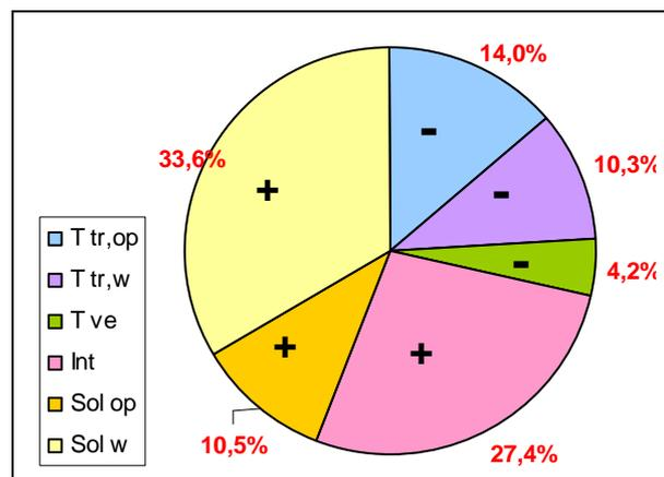
Figura 2.11 Esempio di rappresentazione della metodologia d'analisi termica. Peso, espresso in percentuale, del contributo di ciascuna sollecitazione (positiva o negativa) sul fabbisogno di energia per il raffrescamento dell'edificio nel mese di luglio, in riferimento al caso studio in esame.
