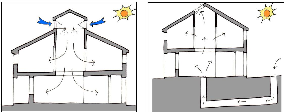
Figura 1.3 Schematizzazione delle strategie di raffreddamento evaporativo, a sinistra, e di raffreddamento geotermico, a destra (fonte: Ford *et al.*, *The Passivhaus Standard in European warm climates. Part 3*, 2007).
