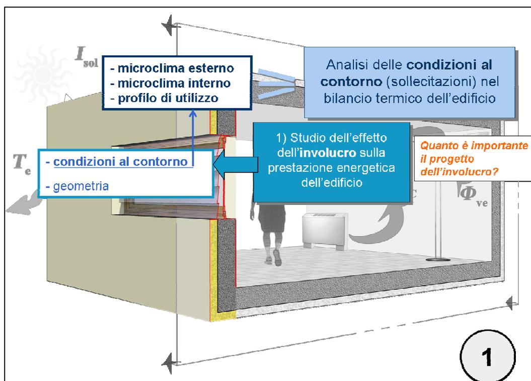
Figura 2.2 Aspetti caratterizzanti l'influenza dell'involucro sulla prestazione energetica dell'edificio (primo livello d'indagine).
