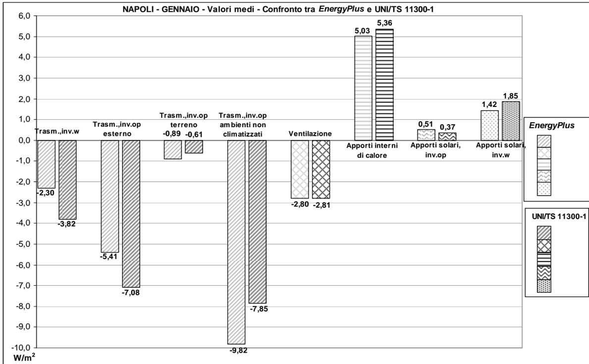
Figura 2.25 Confronto tra i termini dell'equazione di bilancio termico, espressi in termini di potenza termica per unità di pavimento climatizzato, calcolati con EnergyPlus e la UNI/TS 11300-1 (gennaio, Napoli).
