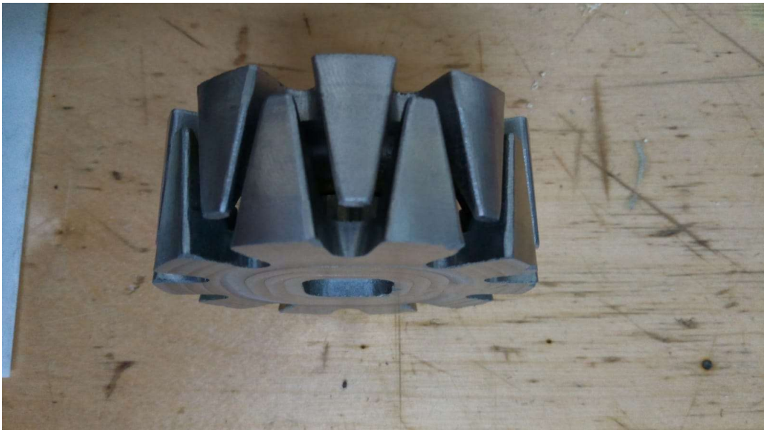
Figura 3-12 Sovrapposizione degli "artigli" del nucleo di macchina
