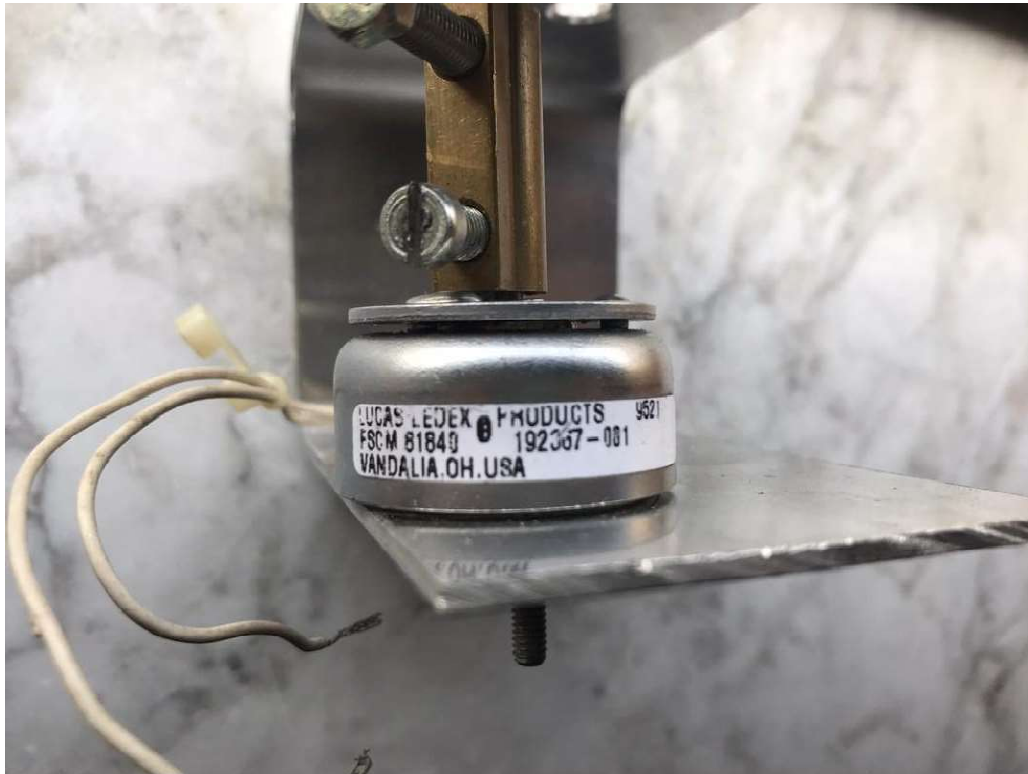
Figura 6-3 Dettaglio di installazione del solenoide rotante
