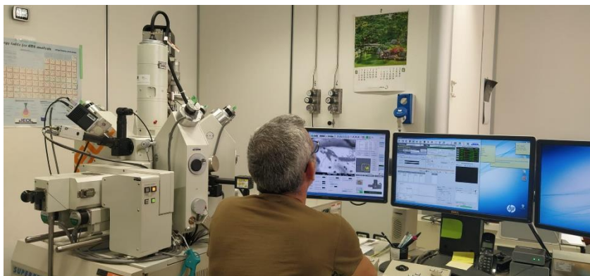
Fig. 39 – Osservazioni e analisi EDS e WDS del biocemento all'EPMA del DiBEST-UniCal.
