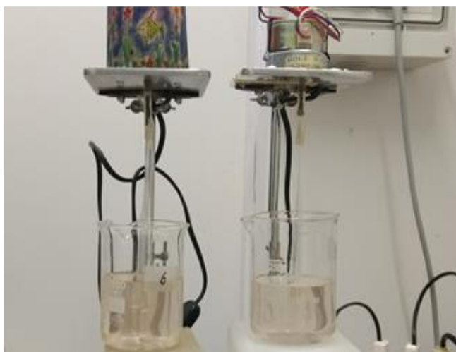
Figura 42. Sistema di agitazione meccanica dell'acqua di mare contenente gli embrioni di riccio di mare in camera termostata a 18°C.
