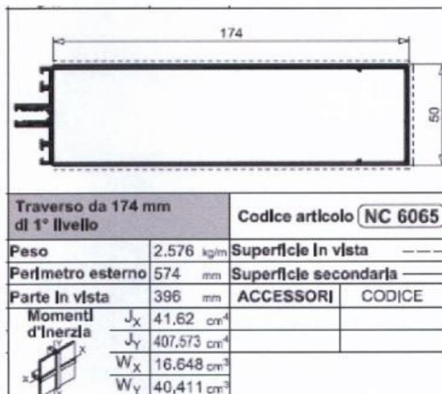
Fig. 4.43 Sezione del traverso del campione pervenuto e sottoposto a prova.
