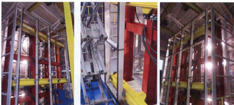
Fig. 4.46 Fasi salienti del posizionamento del campione sull'apparecchiatura di prova. Montaggio montanti, traversi e reticolo montanti-traversi.
