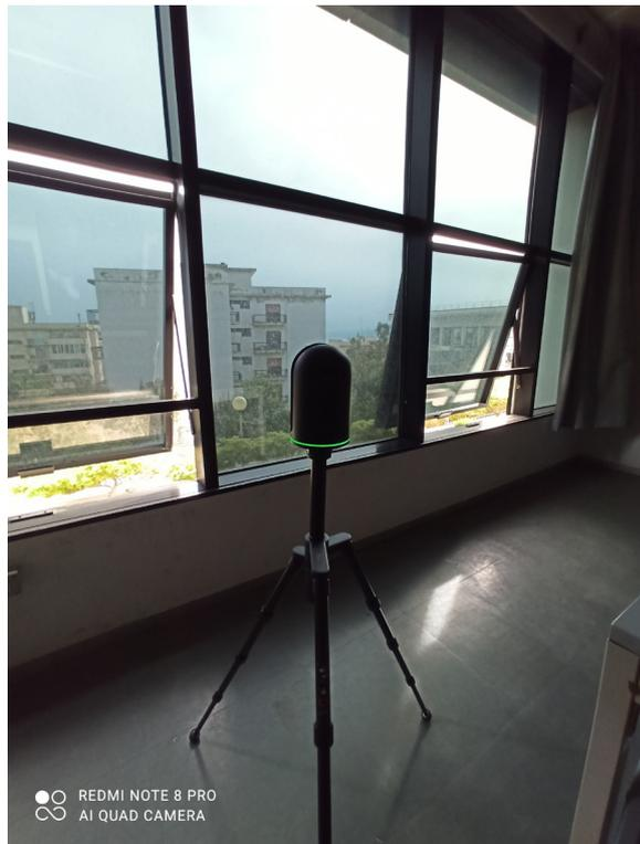
Fig. 4.23 Rilievo mediante laser scanner della facciata Sud del plesso di Architettura dell'Università Mediterranea di Reggio Calabria lato interno (2).
