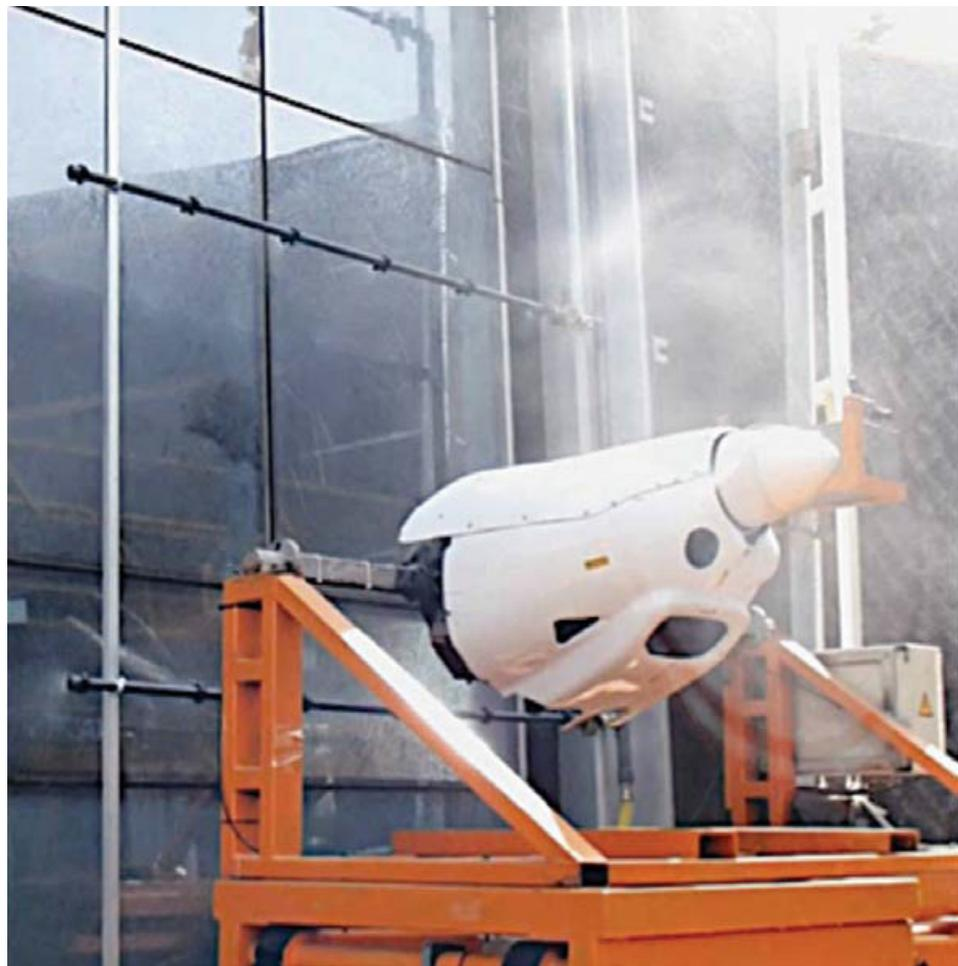
Fig. 3.23 Prova dinamica di penetrazione dell'acqua AAMA 501.1-05. Fonte: Ilter, E., Tavil, A., Celik, O.C., 2015.
