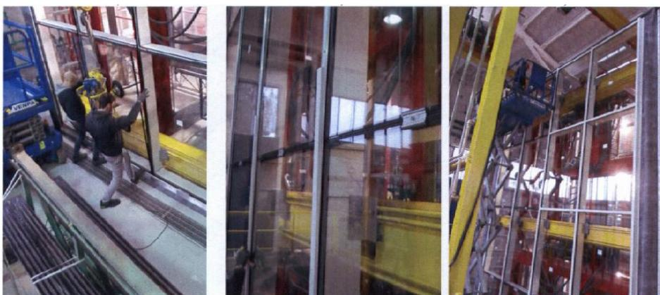
Fig. 4.47 Fasi salienti del posizionamento del campione sull'apparecchiatura di prova. Installazione lastre di vetro, posa di coprigiunti ed altri elementi di completamento, completamento facciata.
