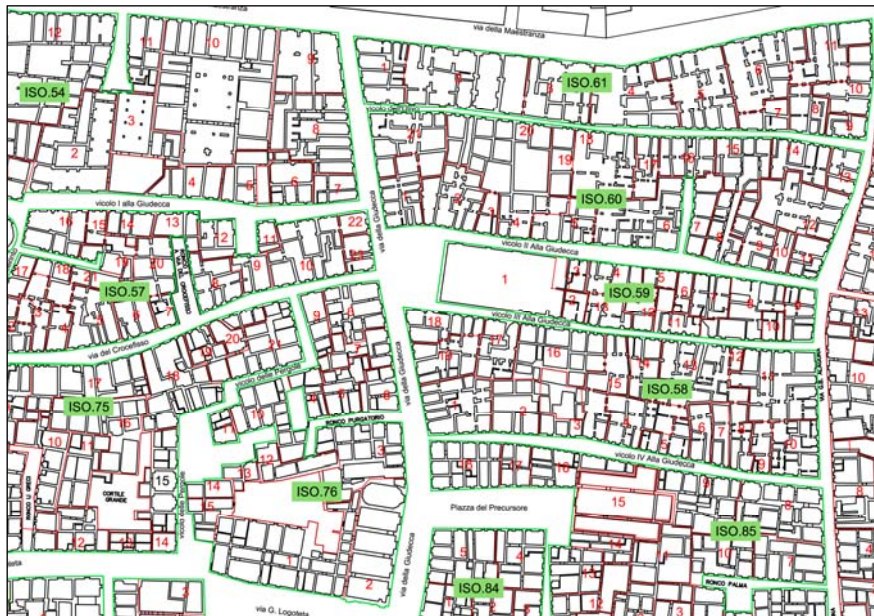
Figura 48 Stralcio della carta base elaborata come risultato della sovrapposizione del rilievo murario del Piano Pagnano all'aerofotogrammetria (Figura 47) e dell'aggiornamento eseguito mediante il confronto con Google Earth.
