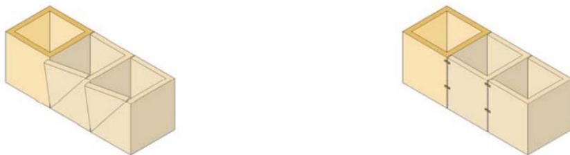
Figura 31 Cellule murarie in aggregato: accostamenti murari in assenza e in presenza di elementi di connessione (morse di attesa).
