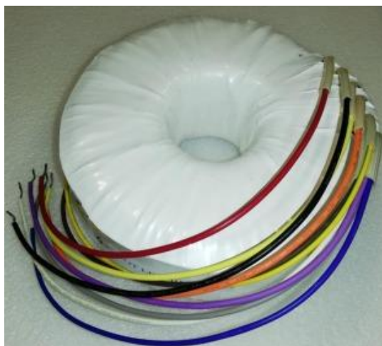
Fig. 113. Trasformatore per uso medico TRIAD MAGNETICS VPM240-4170.
