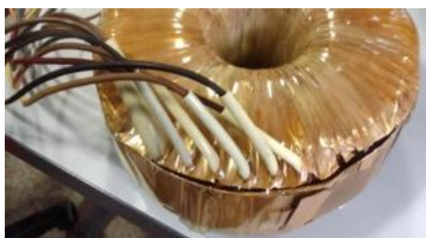
Fig. 117. Stato del trasformatore dopo la prima fase del test di invecchiamento.
