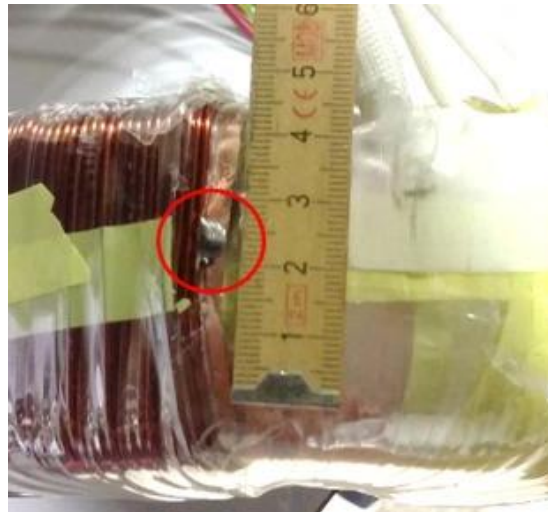
Fig. 119. Saldatura tra lo schermo e l'estremità dell'avvolgimento secondario.
