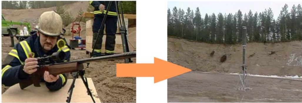
Fig. 41 Prova isolatore da lesione da arma da fuoco
