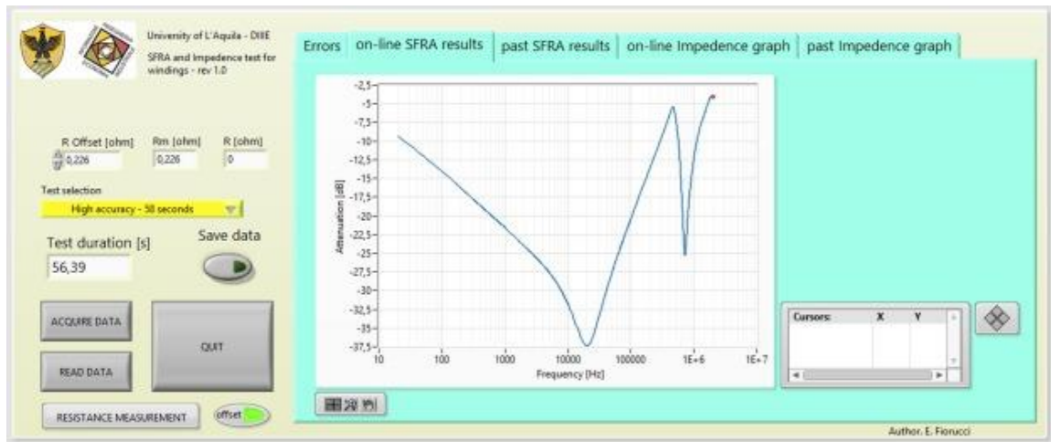
Fig.112 Interfaccia del programma LabView per il test SFRA.
