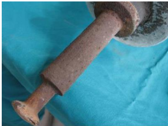
Fig. 22 Ossidazione di una parte metallica dell'isolatore dovuto ad inquinamento
