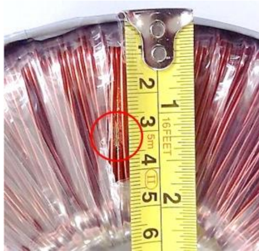
Fig. 120. Cortocircuito ottenuto saldando due spire adiacenti.
