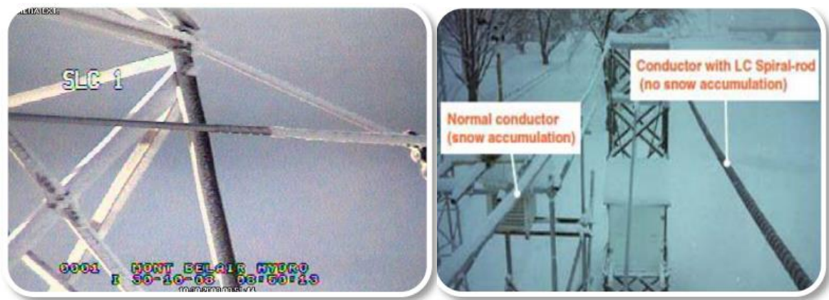
Fig.33 Cavo rivestito con materiale ferromagnetico
