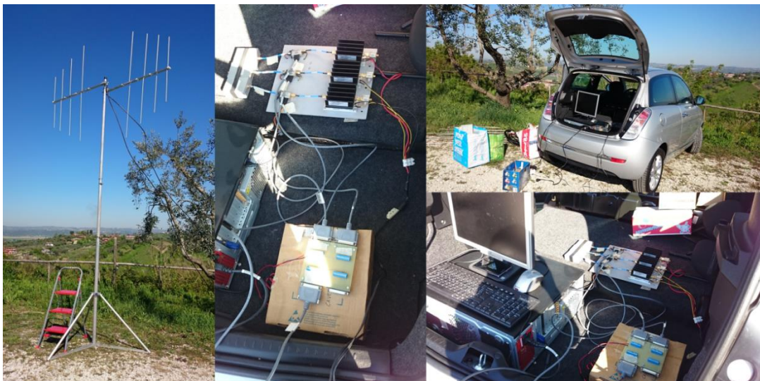
Figura 37. Antenne e front-end utilizzati nelle campagne di acquisizione in configurazione Y.
