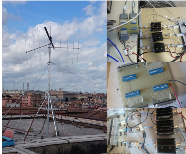
Figura 36. Antenne e front-end utilizzati nelle campagne di acquisizione in configurazione X.
