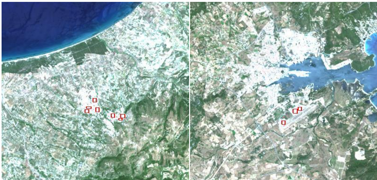
Figure 4.1 Pixel invarianti individuati su un'immagine Landsat8 della Sardegna acquisita il 10/06/2014.
