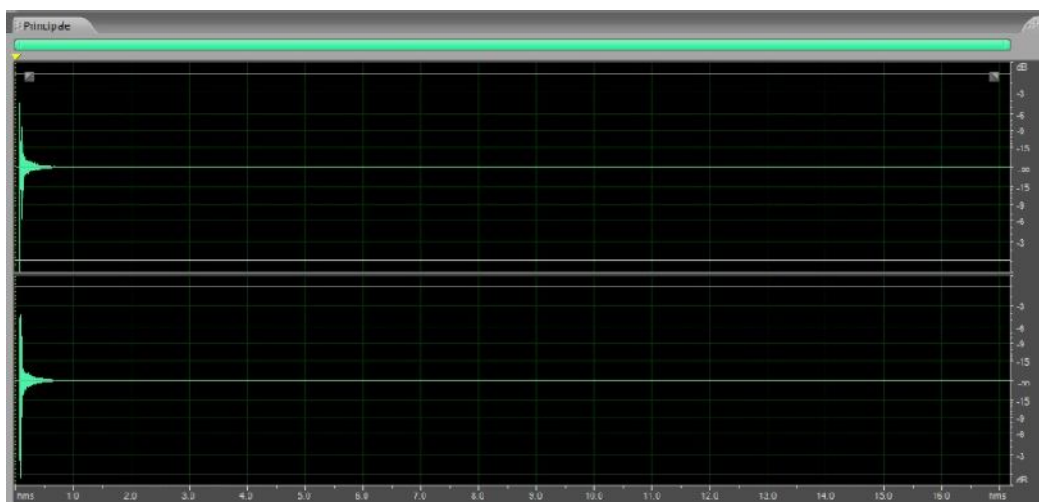
Fig. 7.28 - Impulso binaurale risultante dalla convoluzione di uno sweep e della sua versione rovesciata nel tempo tramite il plugin Convolve with clipboard
