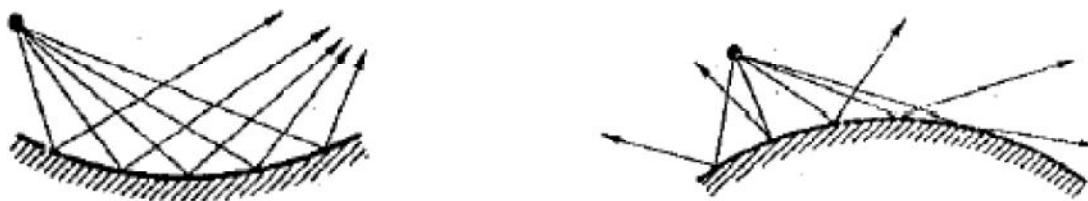
Figura 2.11 - Riflessione su superficie concava (concentrazione dei fronti d'onda) e superficie convessa (dispersione dei fronti d'onda)
