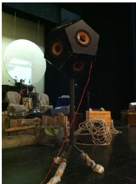
Fig. 7.21 – Sorgente sonora dodecaedrica utilizzata
