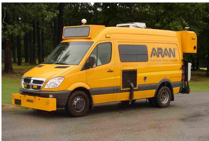
Figura 1-4. Profilometri di Classe II: the Automatic Road Analyzer (ARAN)
