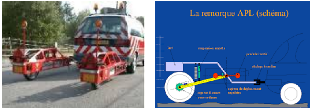
Figura 1-5. Profilometri di Classe III: the Analiseur de Profil en Long (APL)
