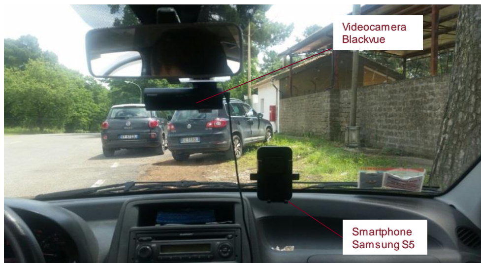
Figura 7-24. Posizionamento videocamera Blackvue
