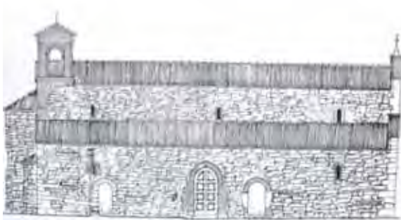
Sommacampagna (VR), pieve di S. Andrea, 1941 ca. Rilievo dello stato di fatto in cui la caratterizzazione del prospetto indica i diversi tipi murari e le tracce di aperture tamponate. A destra: indagini nel sottosuolo all'interno dell'edificio (in F. FORLATI, La pieve di S. Andrea di Sommacampagna , cit., figg. 7, 19).
