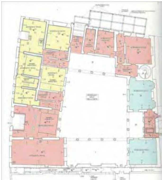
Veduta recente di Palazzo Grimani. A destra: pianta del piano terra con individuazione dei tipi di vasca adottati negli ambienti interni. Il sistema di protezione dalle maree comprende anche un sistema di drenaggio attivo costituito da canalizzazioni ed elettropompe (in C. MENICHELLI, op. cit., fig.1).
