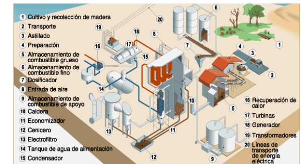
Schema di funzionamento di una centrale a biomassa
