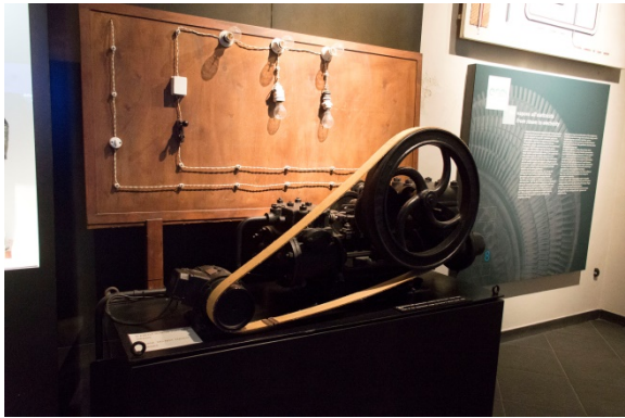
Riproduzione dell'esperimento di accensione di 5 lampadine grazie alla movimentazione tramite il vapore di un motore collegato ad una piccola dinamo, condotto dal Principe Piero Ginori Conti nel 1904
