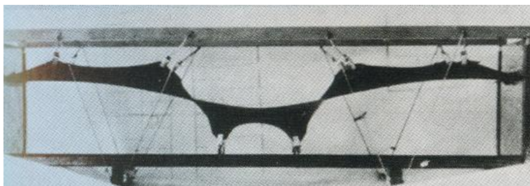
fig. 27 - Secondo modello in neoprene ( Il ponte e la città. Sergio Musmeci a Potenza 2004)
