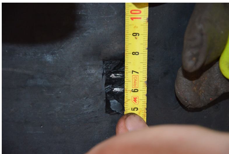
Figure 5.16: Dettaglio sullo spessore degli strati di gomma
