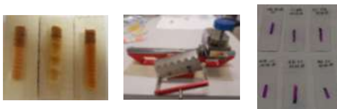
Foto 16. Microcore incollate su supporti di legno, microtomo GSL1 e sezioni trasversali di 10-15 \mu dopo la colorazione (foto R. Proietti).
